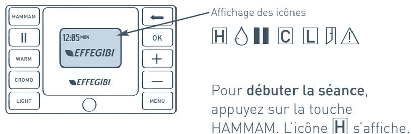
Presser + ou – pour **régler la température** souhaitée. L'afficheur indique SET TEMP, confirmer en pressant OK.
